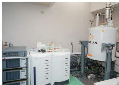
マクロリド化合物の構造解析に使用する核磁気共鳴装置
