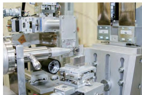
大型放射光施設SPring-8の放射光を用いたK-Pg境界試料の微量元素マッピングの様子
