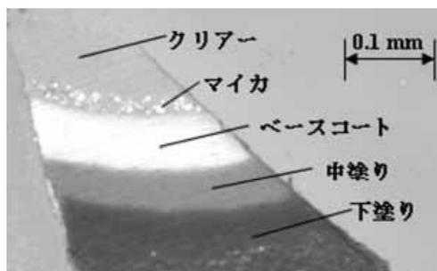
図1 ホワイトパールマイカ自動車塗膜の層構造
