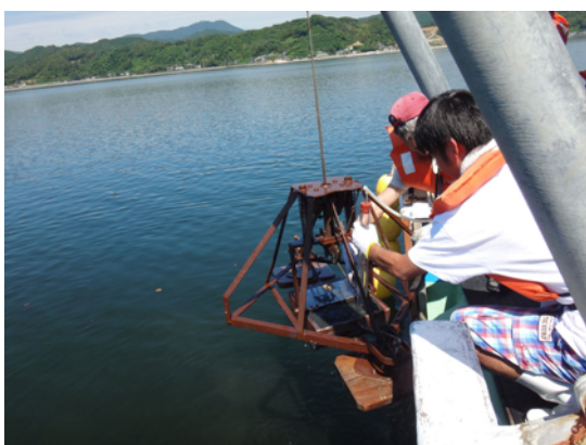
教員と学生が力を合わせて、 採泥器を海に投入する様子
