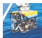
現場化学センサー群を搭載した無人探査機「ハイパードルフィン」
