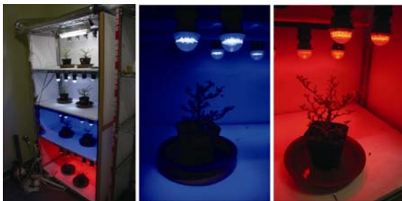
図1. トウガラシのLED照射試験（左上段上から白色蛍光灯、白色LED、青色LED、赤色LED）、中：青色LED、右：赤色LED
