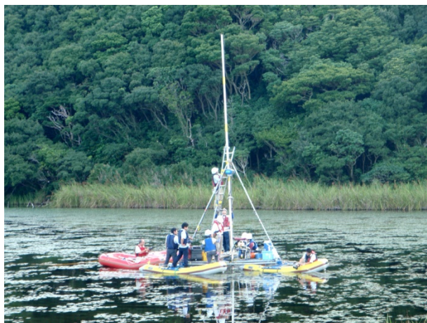
図 1. コアの採取。今年度は 10m の長いパイプを使用して、深い試料採取を試みた。
