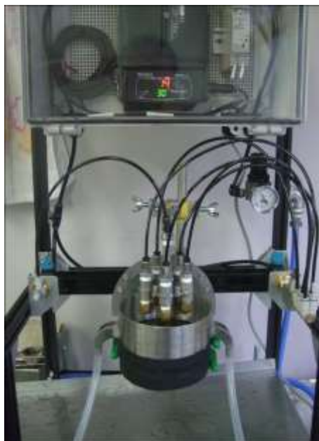
図-1 人工降雨装置に装着した 400cc 採土円筒土壌試料
