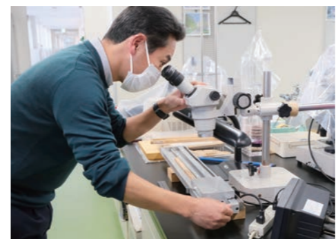
樹木の年輪数や年輪幅を測定する装置を使って過去の成長量を読み解く
