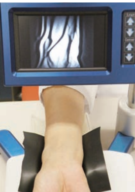
動脈可視化装置（試作機） 近赤外線と赤外線カメラにより 小型モニターに橈骨（とうこつ）と動脈 尺骨動脈が写し出されている。
