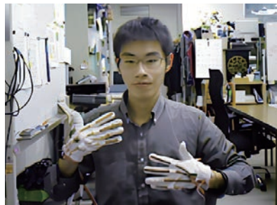
●手話トレーニングマシン センサーを装着した手袋を使って 手話の動きをオンラインで学ぶことができる
