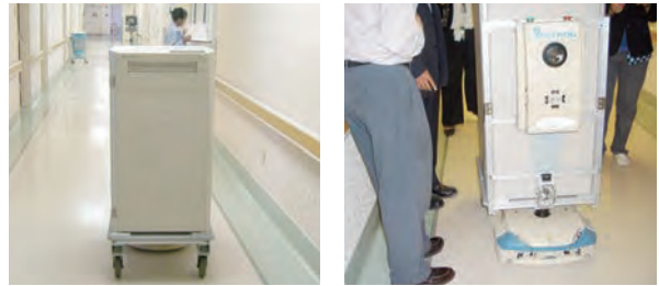
アメリカの病院で使用されていた自動搬送ロボット
