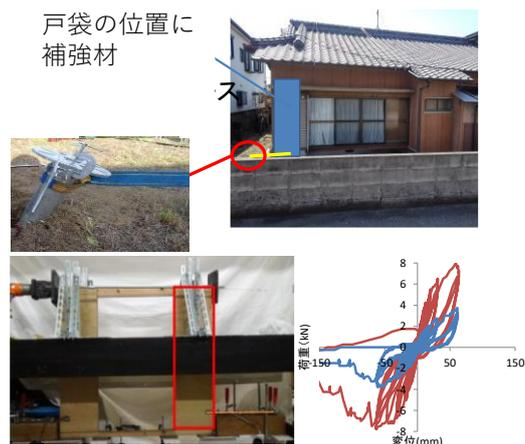
の理由は, 本開発研究で必要となる杭の径は一般的に使われている杭と比べて大変小さく, 式適応の適応範囲外である可能性があること, また, 地表面 1~2メートルと大変柔らかい地層 (N 値で 1 から 4 程度) であり杭打ち込み時に地盤と杭との界面部の土に損傷を与えた可能性があること, 軽量化を目的として幅厚比を限界ぎりぎりに設定したため局所的に部分座屈的な現象が起こった可能性があるなどが考えられた. 安定して水平剛性と水平耐力をコントロールするためには, 打ち込み施工法の開発と杭の断面寸法の最適化が課題として残った.
