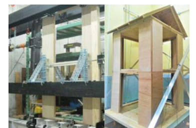
構造成験と 1/3 模型の振動実験の風景
