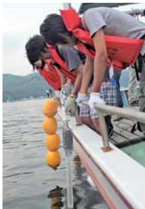
押し込み式コアラーを用いて海底堆積物を採取.
