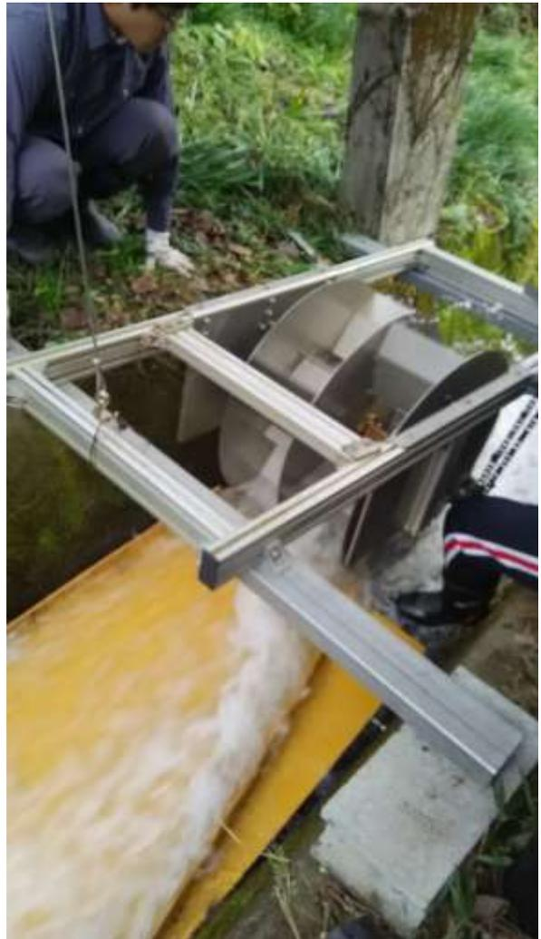
写真：宮古野地区に設置した小水力発電装置
